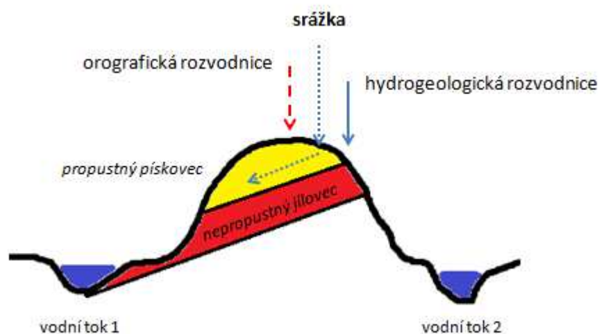
Obr. 2.1 Orografická a hydrogeologická rozvodnice (Pramen: vlastní zpracování).
